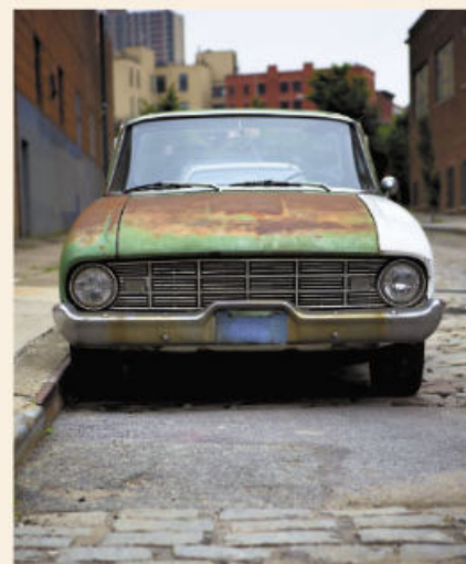
Figura 4.35. En los metales como el hierro se lleva a cabo una oxidación lenta al estar en contacto durante mucho tiempo con el oxígeno del aire o con el agua.
